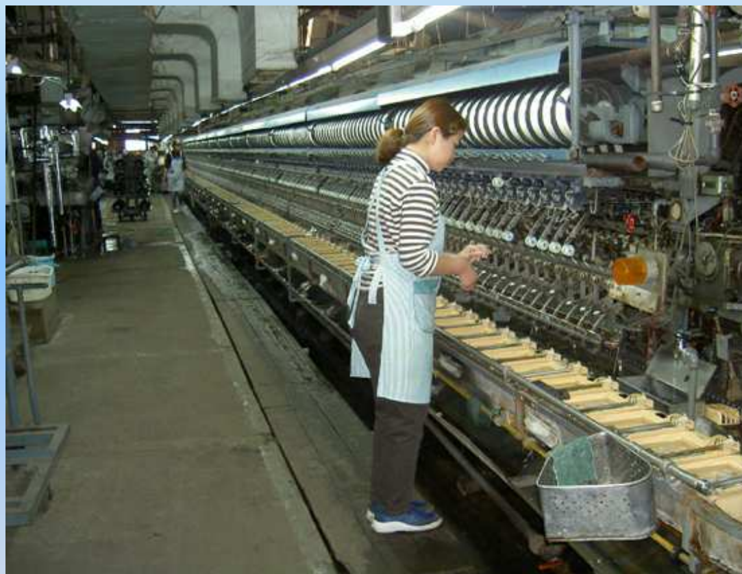
織度感知器を装着したニッサンHR1型自動繰糸機（一例） (碓氷製糸農業協同組合)
